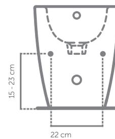
L'apertura posteriore più ampia, permette di riallacciarsi a vecchi impianti di caldo e freddo, fino ad una distanza di 22 cm, senza necessità di interventi sull'impianto.
