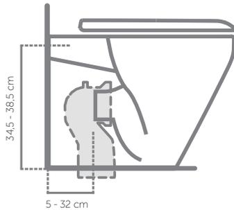
Grazie alle curve tecniche dedicate, copre le distanze degli scarichi preesistenti da un minimo di 5 cm fino ad un massimo di 32 cm. La combinazione con il raccordo eccentrico per l'entrata acqua permette di coprire altezze di ingresso acqua da 34,5 a 38,5 cm.
