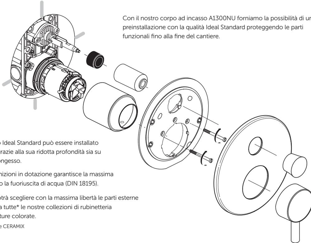
Con il nostro corpo ad incasso A1300NU forniamo la possibilità di una preinstallazione con la qualità Ideal Standard proteggendo le parti funzionali fino alla fine del cantiere.
